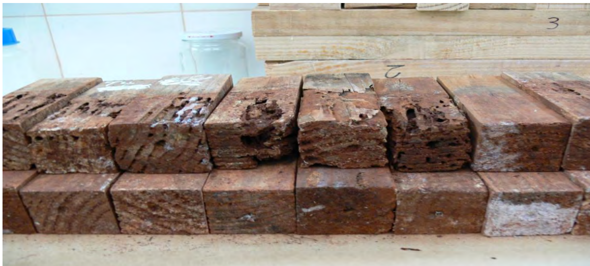
Imagen 1. Fotografía general de las probetas. Las seis probetas de la parte superior, ubicadas a la izquierda son los controles.
