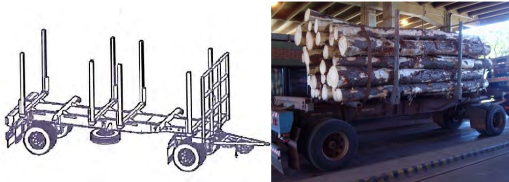
Figura 1 Chasis de acoplado y Carga de acoplado Figure 1 Trailer frame and trailer load
