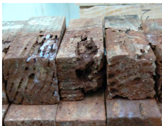
Imágenes 2 y 3. Se observa el detalle del deterioro. Una de las probetas impregnadas (derecha) aparece atacada por un hongo de hifas blancuecinas que no ha podido causar daño a la integridad de la pieza.
