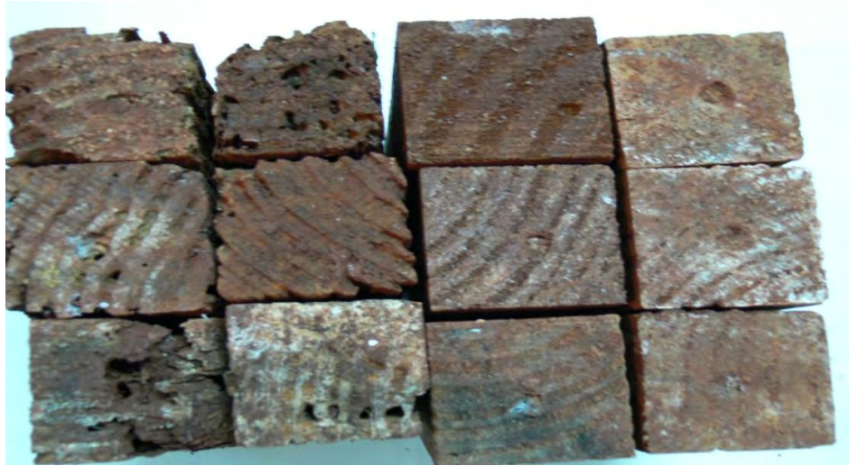
Imagen 4. Visión de la superficie transversal. Izquierda: probetas no tratadas. Derecha: probetas tratadas.
