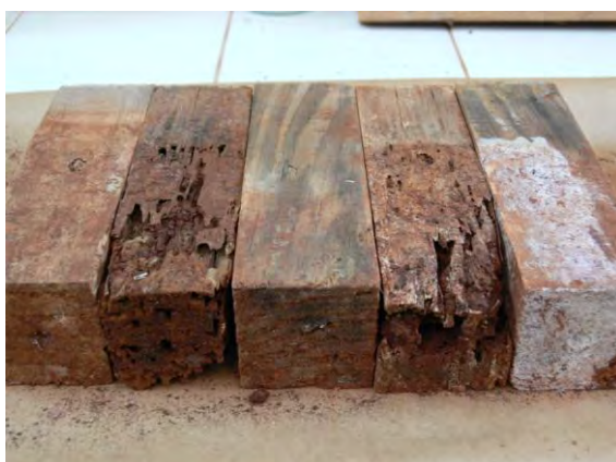
Imágenes 2 y 3. Se observa el detalle del deterioro. Una de las probetas impregnadas (derecha) aparece atacada por un hongo de hifas blancuecinas que no ha podido causar daño a la integridad de la pieza.
