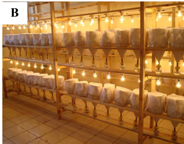
Figura I: Ilustração dos funis extratores. A. Elementos do equipamento (Fonte: SILVA, 2006). B. Visualização da disposição do equipamento (Acervo pessoal).
