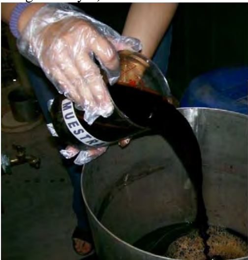
Imagen 5. Preparación de la sustancia impregnante. Image 5. Preparation of impregnating substance
