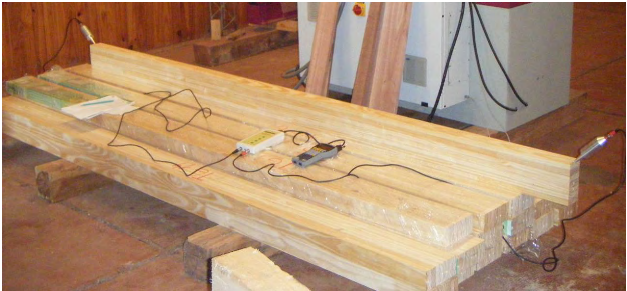
Imagen 1: Medidor de ultrasonido Sylvatest colocado en las vigas multilaminadas utilizadas en el ensayo
