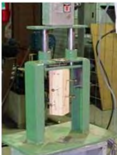
Imagen 2- Dispositivo para ensayo de extracción Imagen 2 - Device to pull test
