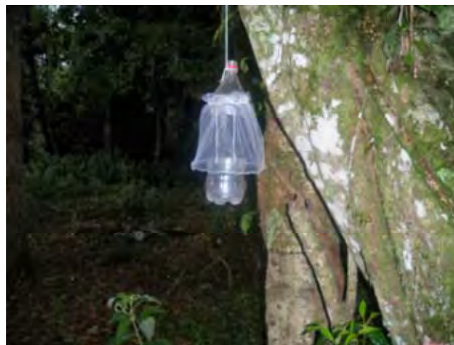
Imagem 1 – Armadilha confeccionada tipo Malaise , que intercepta os insetos em vôo, disposta a 1,5 m de altura. Image 1 - Trap made from type "Malaise", which traps the insects in flight, ready to 1,5 m high.
