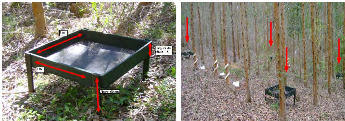
FIGURA 1: Aspecto de um coletor de serapilheira e suas dimensões e a distribuição destes na respectiva parcela.
