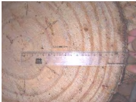
Fotos 1 y 2: Rajaduras radiales en el 4 to anillo de crecimiento en ejemplar de Pinus taeda L. en rodal DC11 y tabla afectada por las mismas.
