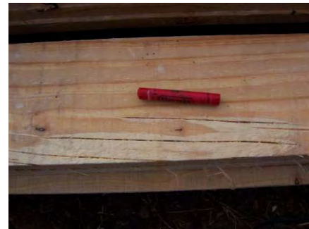
Fotos 1 y 2: Rajaduras radiales en el 4 to anillo de crecimiento en ejemplar de Pinus taeda L. en rodal DC11 y tabla afectada por las mismas.
