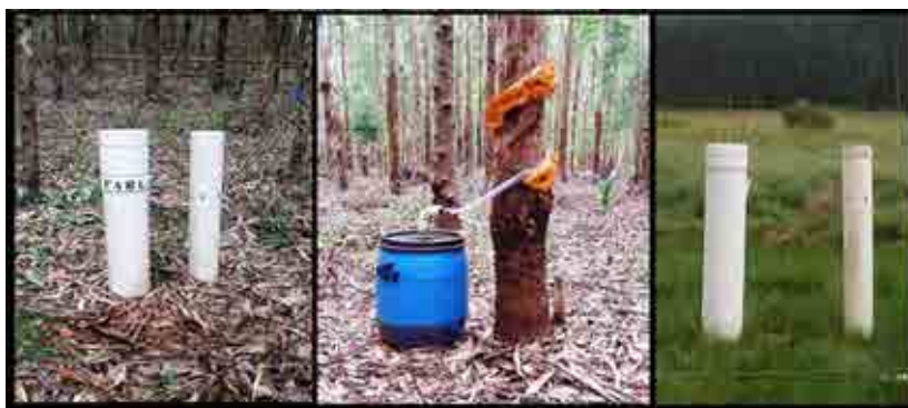
Figura 3: Aspecto dos coletores de precipitação interna (Pi), escoamento pelo tronco (Et) e precipitação pluviométrica (P) respectivamente da esquerda para a direita, em Eucalyptus dunnii aos 8 anos de idade no sul do Brasil.
