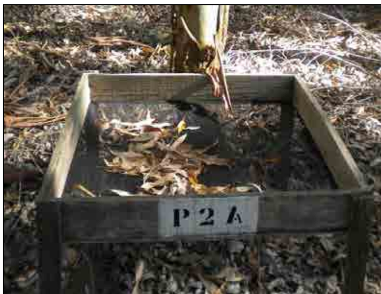
Figura 1: Aspecto de um coletor utilizado na coleta de folhas.
